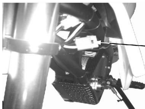
Boîte à fusible
