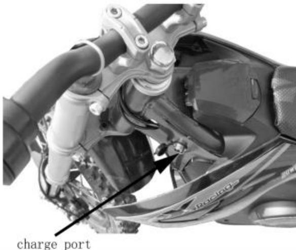
Le port de charge est situé sur le côté avant gauche du cadre (voir photo ci-dessus)
