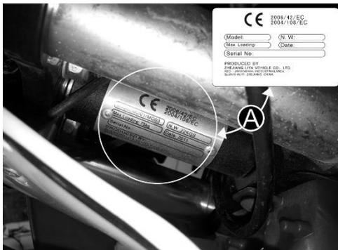
Le code PIN est marqué sur une plaque d'aluminium rivetée sur la colonne de direction.
