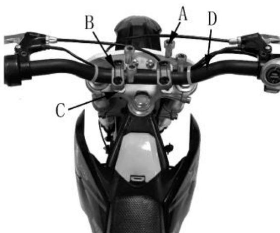
1. Placer le guidon (D) sur le support (c), couvrir avec les pontets (B).
