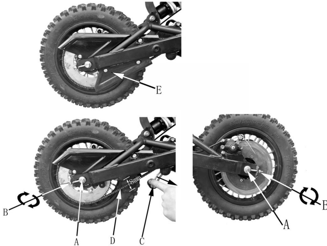
**Étape 1 :** Retirez le couvercle de la chaîne (E) avec la clé allen de 4mm.
