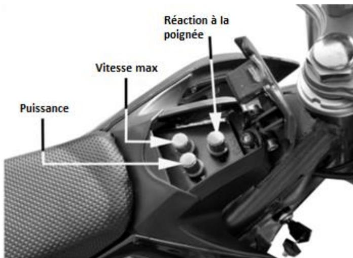
L'interrupteur réglable à 3 fonctions est situé sous un couvercle en plastique qui se trouve à l'avant De la selle (voir photo ci-dessus).
