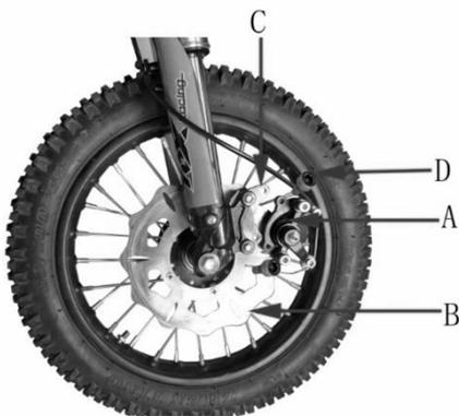
1. Placez le disque de frein (B) dans l'étrier de frein (A), alignez le trou du support (C) sur la platine de montage de l'étrier (A).
