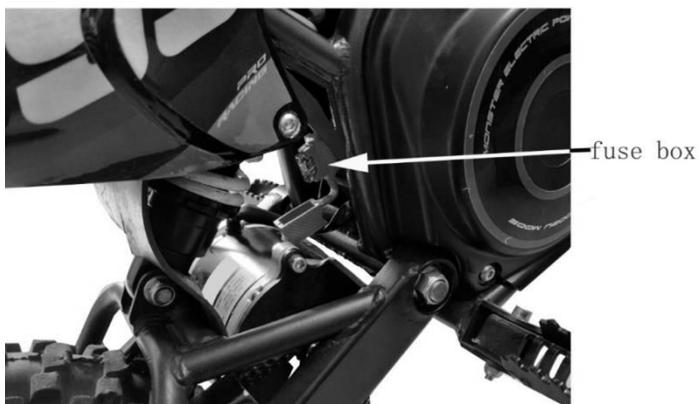
1. La boîte à fusibles est fixée sur le côté droit du cadre, au-dessus du moteur.
