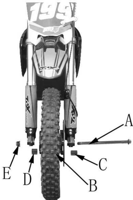
Montez l'axe de roue (A) à travers la fourche gauche et insérez l'entretoise (C) / la roue (B) / entretoise (D) en séquence, puis faites passer l'axe à travers la fourche droite.
