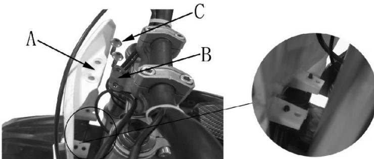
1. Alignez et insérez les trous inférieurs de la plaque (A) 2 aux ergots du garde-boue avant.
