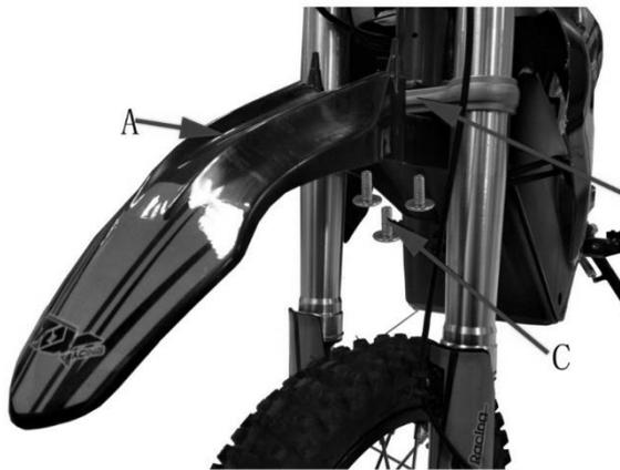
1. Placez le garde-boue avant (A) sous l'attelle vers le bas (B) et alignez le garde-boue sur les 3 trous d'attelle.
