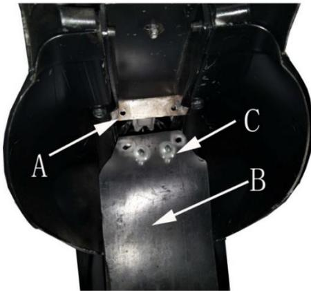
1. Alignez la bavette (B) avec les 2 trous sur le support sous le siège, et fixez le boulon (C)
